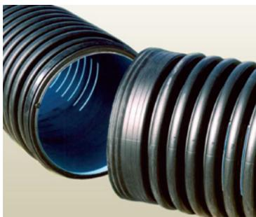
Tubi in PEAD per drenaggio, doppia parete con superficie esterna corrugata ed interna liscia. Barre da m 6 complete di manicotto di giunzione e guarnizione elastomerica. Foratura eseguita con tagli di spessore 2,5 - 3 - 4 mm (in base al diametro).
